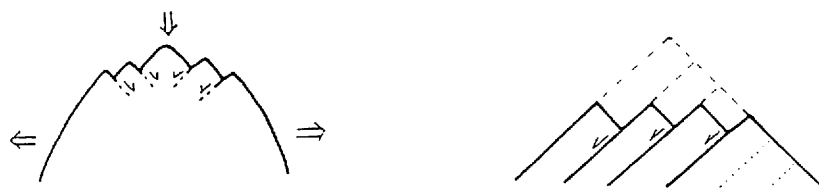
A 重力性正断層運動による稜線の陥没
