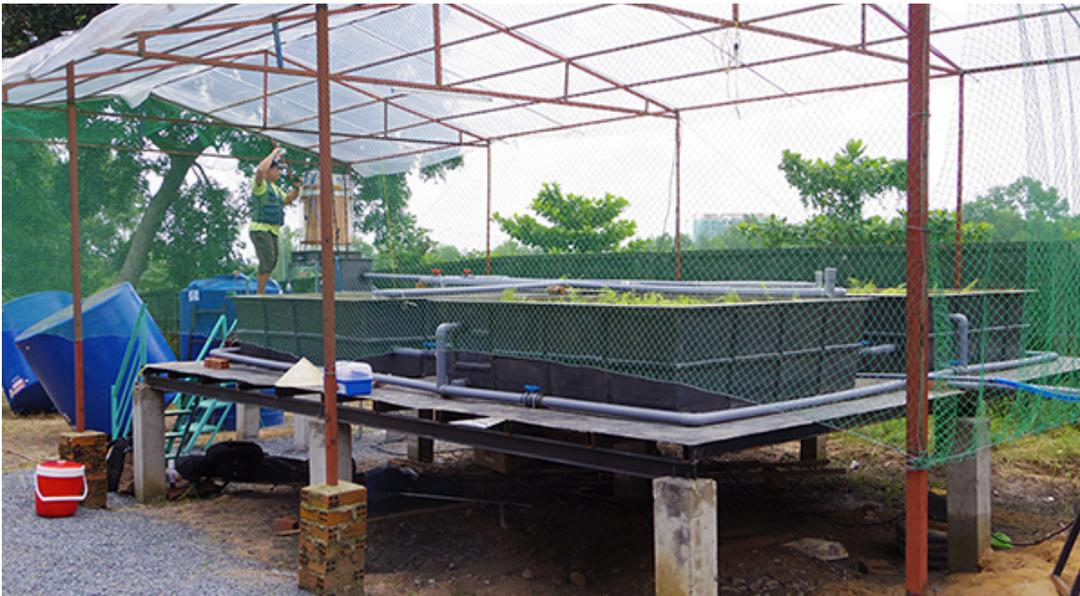
図-9 ベトナム・ホーチミン市に設置したモエジマシダ水耕栽培ヒ素除去実験用パイロットプラント
